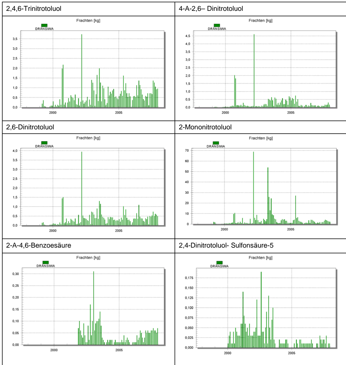
Abb. 26: Frachtentwicklung an der TRI-Halde ab 1998 (exemplarische Darstellung für den Tiefendrain, Angaben in kg/Monat)
